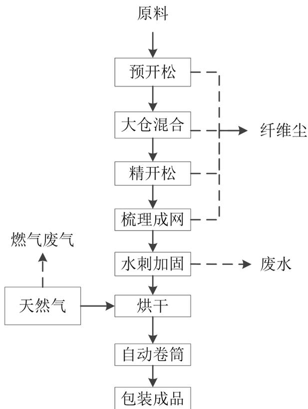
图 5-1 水刺无纺布工艺流程图
