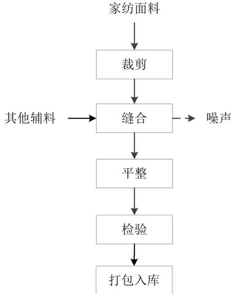
图 5-4 家纺制品工艺流程图
