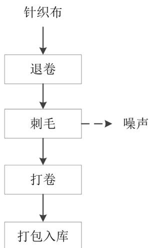
图 5-2 刺毛面料工艺流程图
